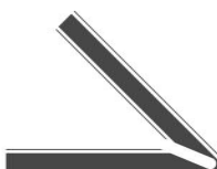
135° V-Nut Fräsung für Abkantungen bis 135°
