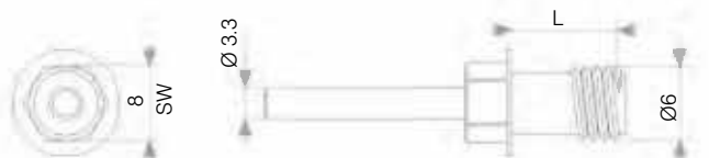
Abb. Nietschraube TU-S6,0x9 - Konstruktion und Abmessungen (mm)(mm).
