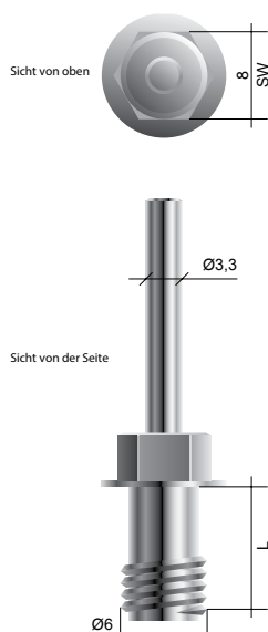
Abb. Nietbolzen – Ausführung und Abmessungen (in mm)
