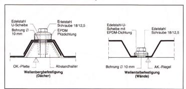
**Schrauben:** Die Dachbefestigung erfolgt auf dem Wellenberg Abstandshaltern. Im Wandbereich im Wellental befestigen. Befegungen sind entsprechend der ONDEX®-Bau-anleitungen und bau-aufsichtlicher Zulassung auszuführen.
